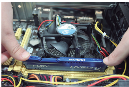
Figura 2.7 Instalación de memoria RAM en un equipo
