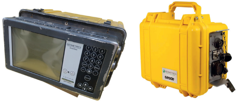
FIGURA 2.11. Sismógrafos de la marca Geometrics: SmartSeis S-24 (izquierda) y Geode, Geometrycal® (derecha). Este sismógrafo necesita de su conexión a un PC para su funcionamiento.
