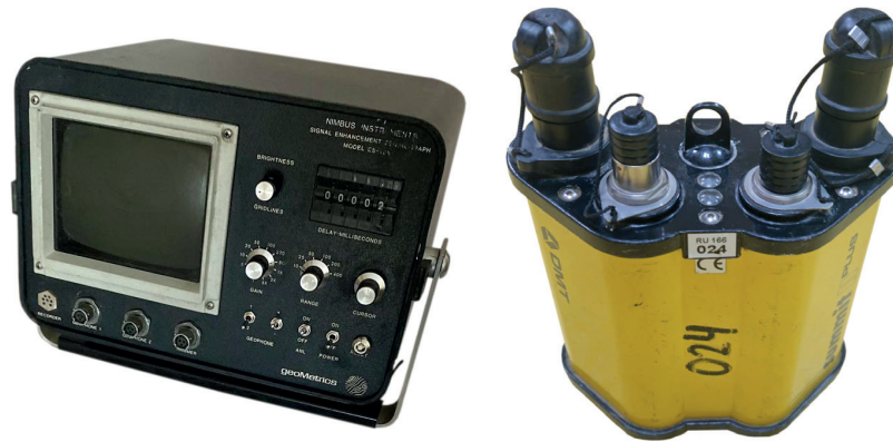
FIGURA 2.7. Sismógrafo analógico de dos canales Nimbus ES-125 (de la empresa geoMetrics); la determinación del tiempo de llegada de las ondas P o S se hacía sobre la señal sísmica registrada con forma sinusoidal y analizada en campo (izquierda) y unidad sísmica digital de dos canales Summit II Plus System (de la empresa DMT); las señales sísmicas son transmitidas a un ordenador a través de un cable junto con las restantes colocadas en campo formado un perfil (46, 92, 120, etc.) (derecha).
