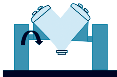
Figura 2.8. Mezclador de sólidos móviles en V.
