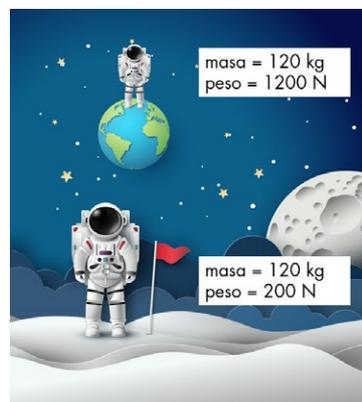
**Figura 2.1.** Diferencia entre masa y peso
