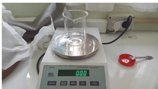
**Figura 2.8.** Para efectuar una pesada hay que tarar el recipiente
