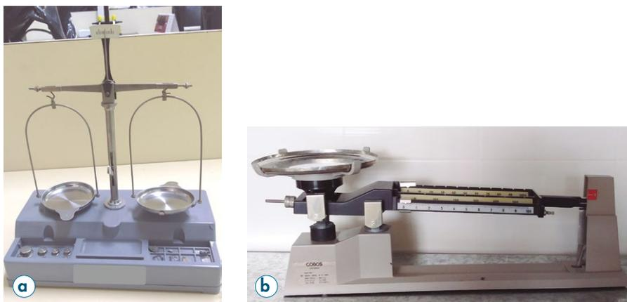
**Figura 2.2.** Balanza mecánica de doble plato (a) y balanza mecánica monoplato (b)
