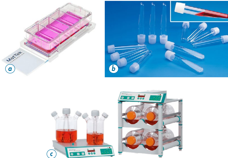
Figura 2.8 a) Cámaras de cultivo sobre portaobjetos, MatTek®, b) tubos truncados, Nunc®, c) botellas para incubadoras tipo roller , Pfeiffer®
