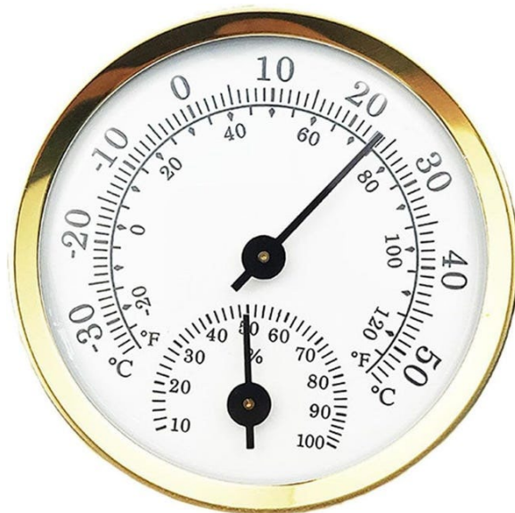
Figura 2.2. Termómetro-higrómetro. Mide la temperatura y el grado de humedad del aire o el de otros gases.
