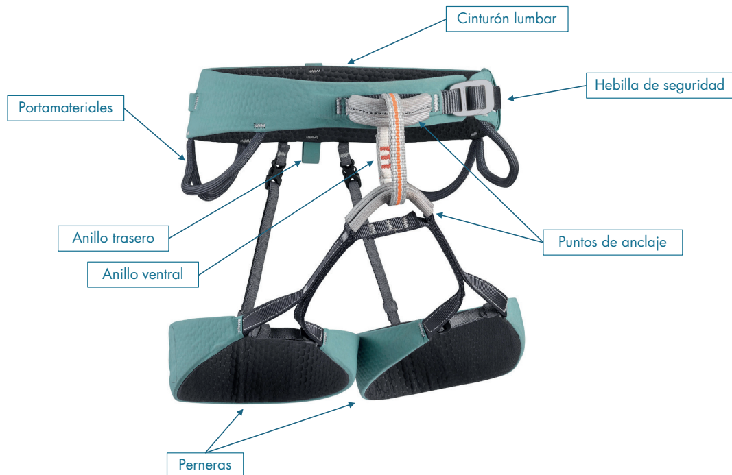
Figura 2.4 Partes de un arnés de escalada
